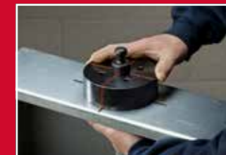
Dobra widoczność miejsca pracy dzięki podziałce na matrycy umożliwia szybkie i dokładne zastosowanie
