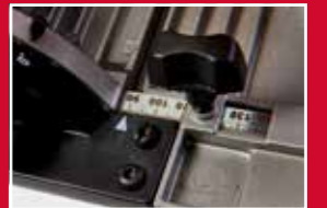
Podwójna prowadnica mocowana z przodu i z tyłu
