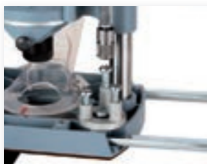
Obrotowy zderzak rewolwerowy umożliwia szybkie nastawienie 3 typowych głębokości frezowania.
