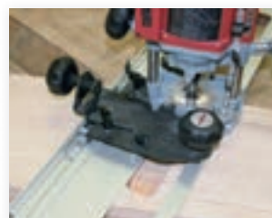
Szyna prowadząca do frezowania połączeń teowych w policzkach schodów o maksymalnych wymiarach: 640 x 60 mm (dostępna jako dodatkowe wyposażenie).
