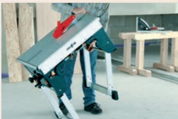
Montaż i demontaż pilarki stołowej ERIKA 85 Ec to prosta obsługa dla jednej osoby. /Quickstand\ można beznarzędziowo rozłożyć w zaledwie kilka sekund.
