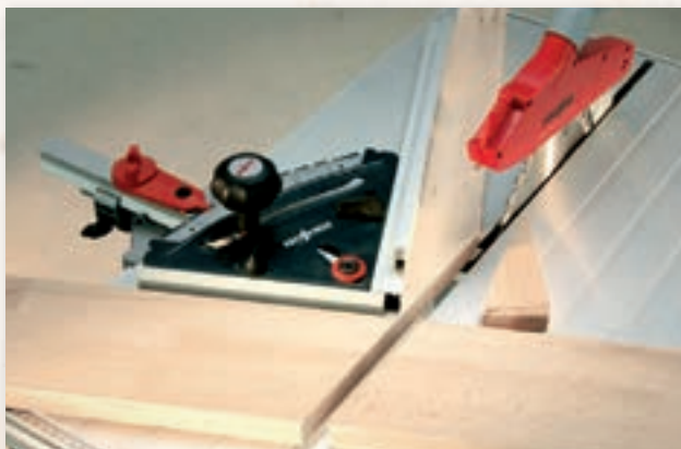
Multifunkcyjna przykładnica kątowa MFA umożliwia wykonanie dwóch cięć skośnych bez konieczności ...
