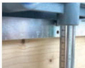
Odległość od krawędzi materiału w pionie jest ustawiana dokładnie według skali.
