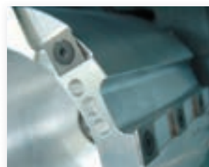
Nowa głowica z nożami czterostronnymi HM dla maksymalnej efektywności frezowania i optymalnego odciagu wiórów.
