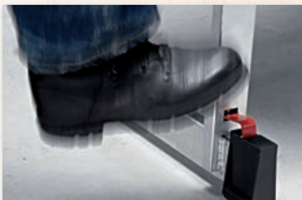
Dotknięcie stopą - to wystarczy, aby ustabilizować pilarkę stołową na nierównym gruncie.
