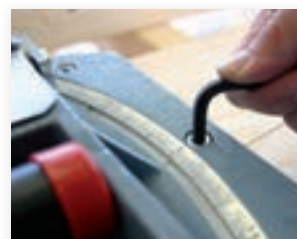
Przystawkę do dłutownicy można nastawić pod kątem do 45° w obu kierunkach.
