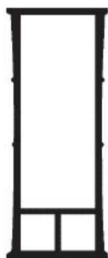
Przekrój poprzeczny profilu poziomnicy z serii PRO900.
