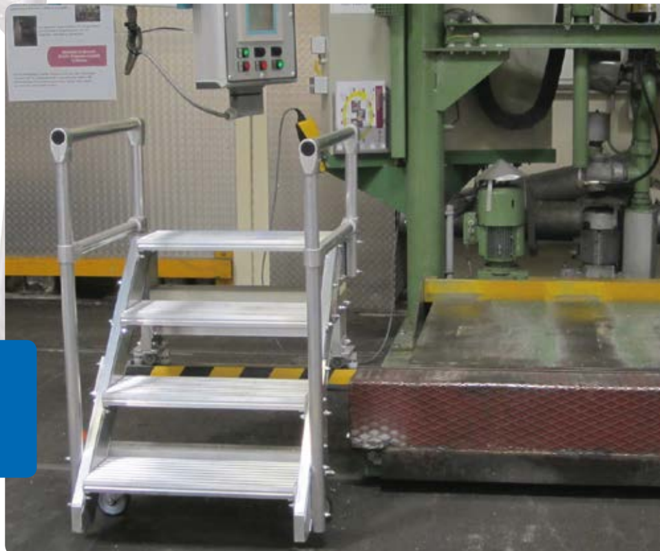
Mobilny podest robo- czy prowadzony przy maszynie
