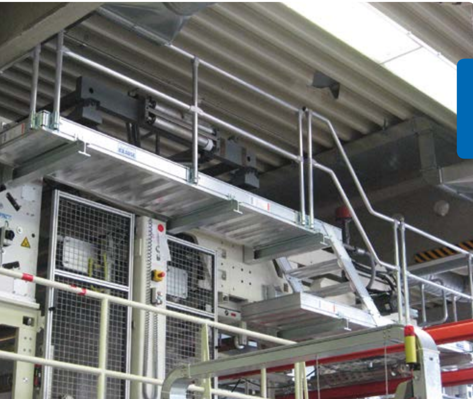
Platforma konserwacyjna z dwoma poziomami roboczymi, mocowana na stałe
