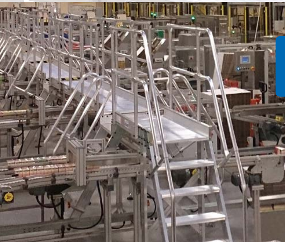
Przeście stacjonarne mocowane na stałe do podłoża
