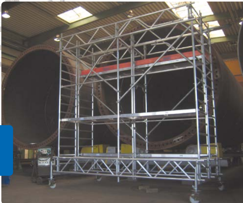
Konstrukcja z rusztowań jezdna łącznie z urządzeniem ułatwiającym przenoszenie za pomocą dźwigu
