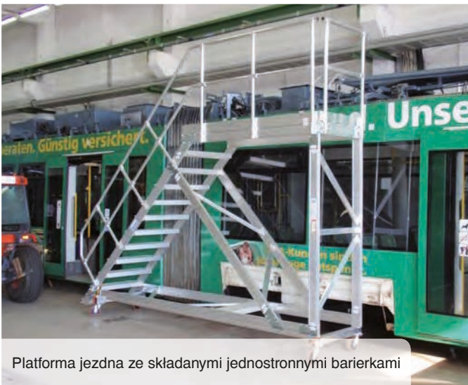
Platforma montażowa jezdna ze składanymi barierkami.
