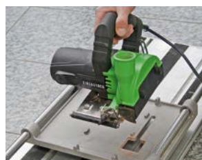
Montowanie piły bez użycia narzędzi
